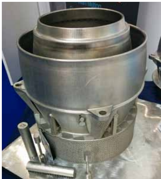
Tuyère moteur DGEN sur plateau de fabrication / Price Induction & Poly-Shape.
